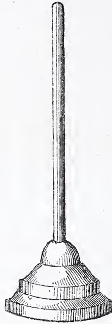
FIG. 4. Plomb à bobines.
